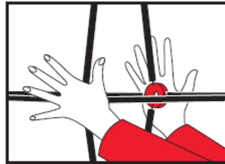
Drücken Sie die Naben vorne und hinten zur Mitte des Rahmens, bis das Gestell sich selbständig verriegelt/ einrastet. Die roten Boden-Markierungen/Bolzen zeigen nach vorne.
