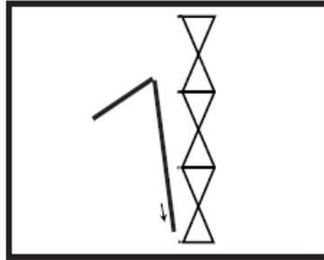
Unteres Ende („Down“) der Magnetschiene in den sich am Fuß des Displays befindlichen roten Stift von oben drauf schieben.
