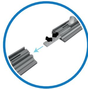
Verbinden Sie die vertikalen / horizontalen Profile indem Sie die vorinstallierten Verbindler in die dafür vorgesehenen Kanäle einfügen und die 2 mitgelieferten Rändelschrauben fest anziehen.
