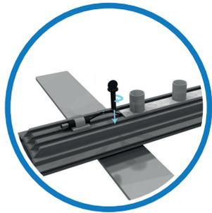
Montieren Sie mit Hilfe der mitgelieferten Rändelschrauben die Füße an das entsprechende BrightWall-Profil.
