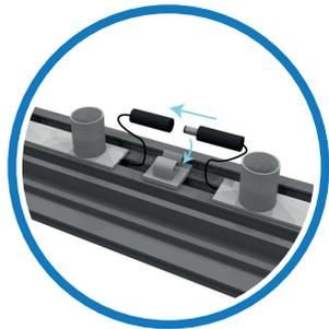
Stellen Sie sicher, dass alle Lichtmodule wie im obigen Schaubild dargestellt miteinander verbunden sind und die Stecker dann in die dafür vorgesehenen Clips eingefügt werden.
