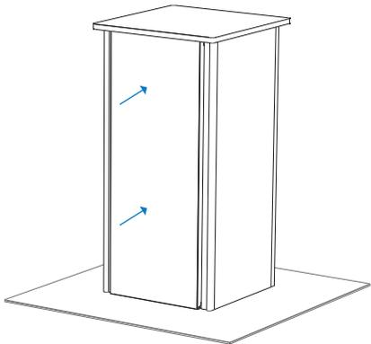
**Schritt 2:** Bringen Sie den Lightblocker auf der Rückseite an und verbinden Sie die Kabel in Pfeilrichtung. Wenn alle Kabel verbunden sind, schließen Sie die Leuchten an den Transformator an.
