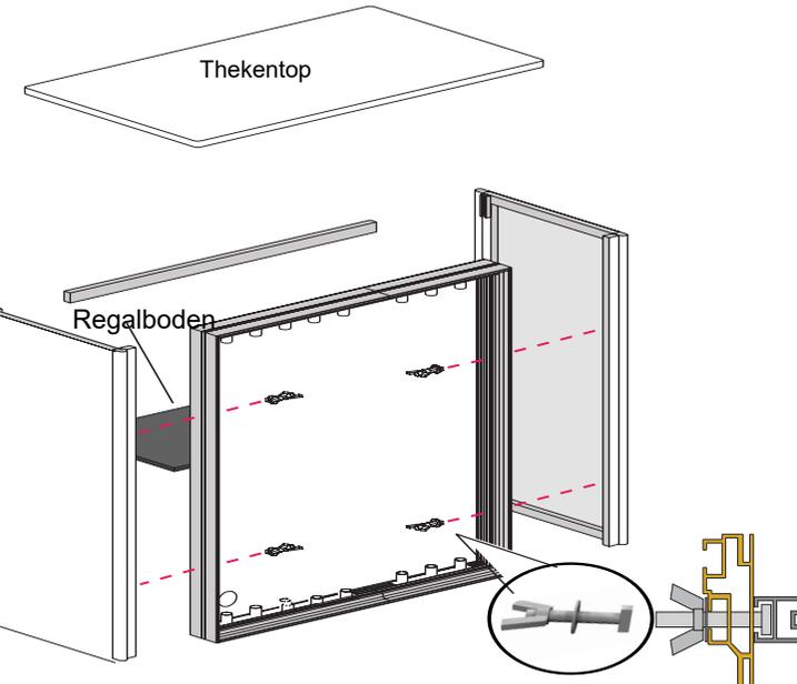
Schieben Sie die T-Schraube durch den Brightwall-Rahmen und setzen Sie Flügelmutter und Unterlegscheibe auf der Innenseite des Rahmens ein. Setzen Sie das "t" in den Kanal A1 und drehen Sie die Schraube zum Einrasten.
